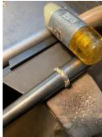
rundgeschmiedet, innen etwas rund gefeilt und auch außen das Kantige durch feilen rundgeformt. Ein ganz besonderes Paar Trauringe, dem ich die Beschäftigung mit dieser ganz alten Technik der Herstellung eines Fugen-
