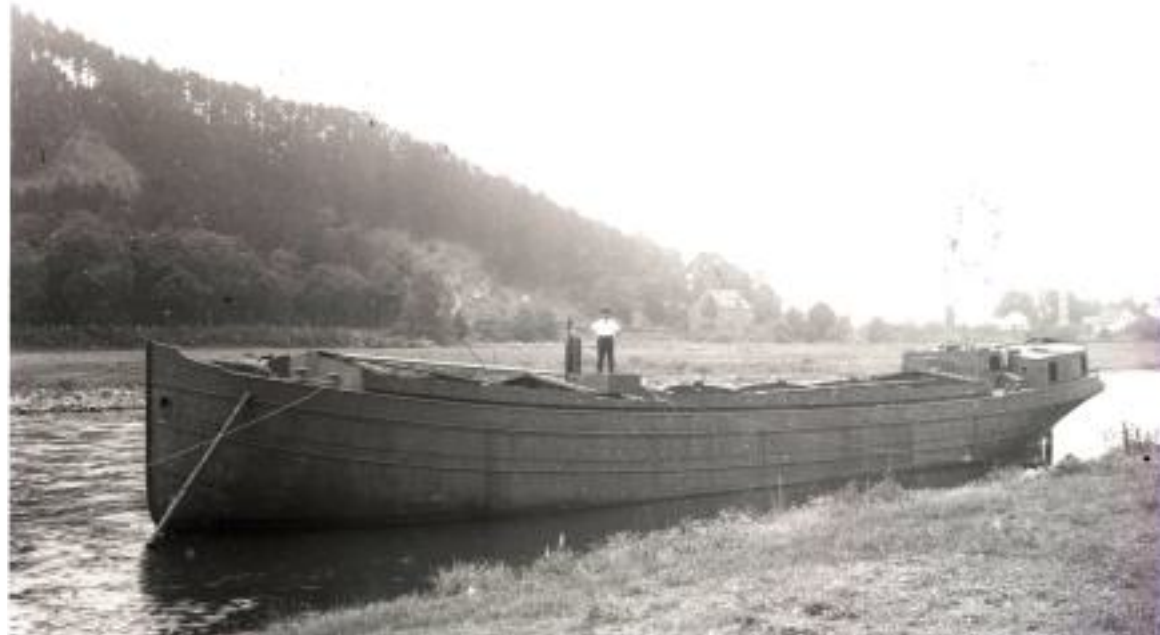
Das Kasko eines kleinen Motorschiffes der Neubauserie Nr. 119-121 liegt nach dem Stapellauf am Weserufer"
