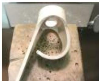
ausgesägt, anschließend wird die Ringschiene rund gebogen und unten zusammengelötet. Nach dem Richten auf dem Ringriegel wird der Ring in die passende Form gefeilt und die Kanten abgerundet. Nach dem Schleifen wird die Oberfläche durch Hammerschläge verziert. Nun wird noch der Stein gefasst und die Fassung nachgearbeitet.
