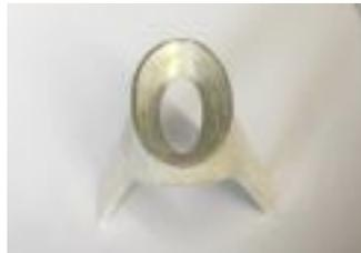
In die Fassung wird ein Stück Silberblech eingepasst und als Steinauflage in die Fassung gelötet.
